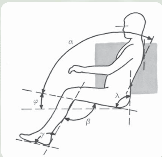
Definitie van de hoeken die in het sagittale vlak een zithouding bepalen
